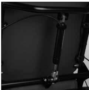
ED 20 Mech. Rücken- winkelverstellung über Gasdruckfeder
