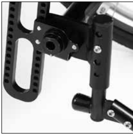
Antriebsradaufnahme (mit Zubehöraufnahme für Kippschutz/Ankipphilfe)
