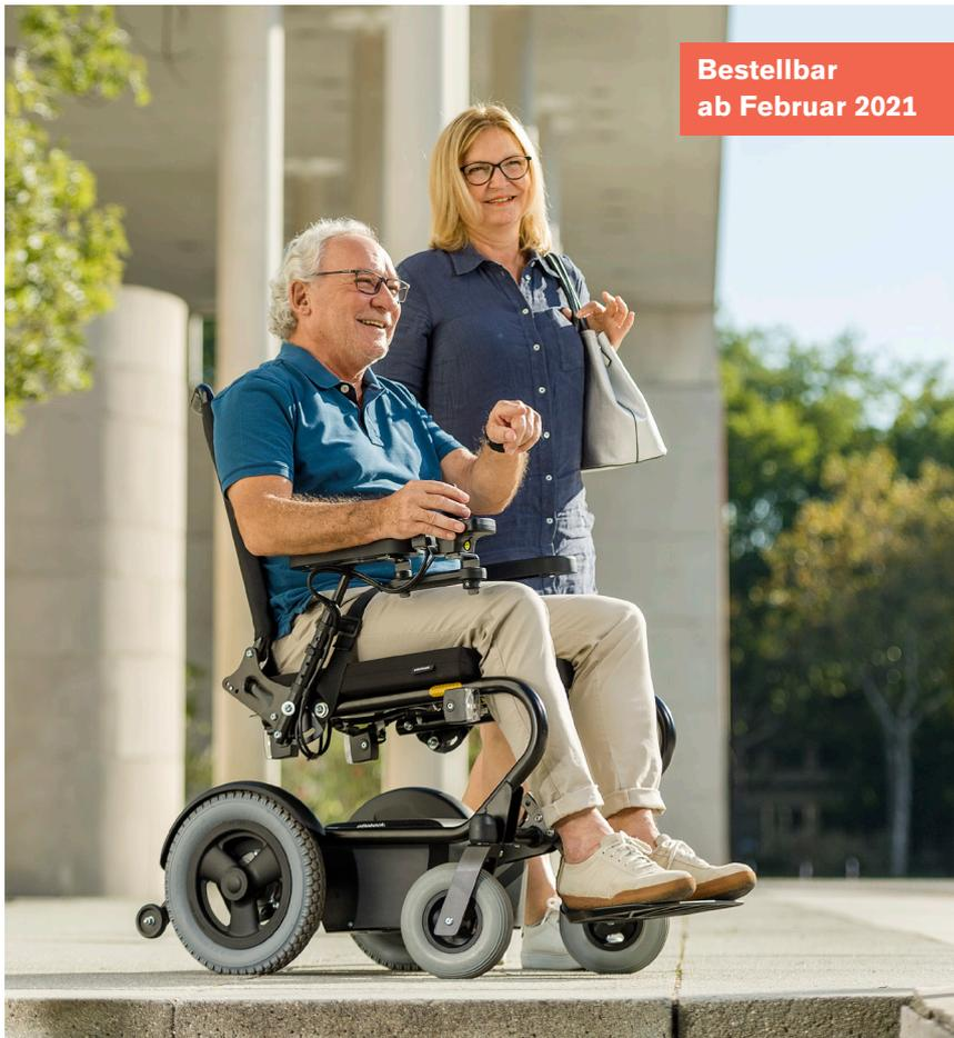
Der Wingus ist ein heckangetriebener Sit'n'Drive Elektrorollstuhl, welcher gleichermaßen für den Innen- und Aussenbereich geeignet ist. Dieses kompakte und wendige Modell verfügt über eine innovative selbstfedernde Rahmenkonstruktion, welche für hohen Fahrkomfort sorgt. Er kombiniert langzeitgeprüfte Funktionalität mit einem ansprechenden und minimalistischen Design: *Verlässlichkeit made in Germany.*
