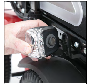
ES021 Elektrische Beleuchtung
